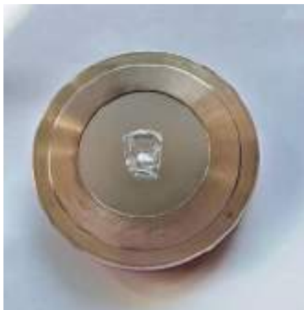
Figura 202 Posizionamento del campione per analisi al diffrattometro a raggi X
