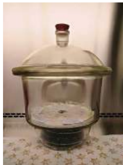
Figura 222 Nella figura di sinistra si ha il posizionamento dei campioni all'interno del primo essiccatore alla temperatura di 37°C; nella figura di sinistra, destra si osservano i campioni all'interno del secondo essiccatore a 20°C
