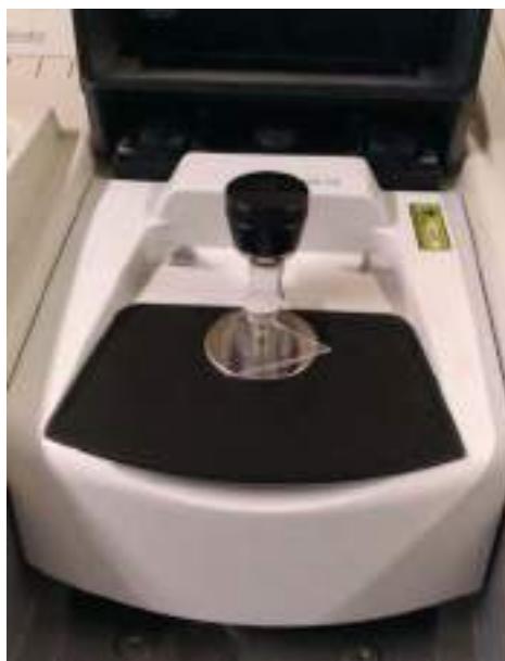
Figura 113 Posizionamento del campione all'interno dello spettrometro IR
