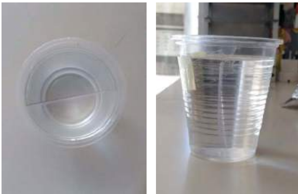
Figura 126 Campione in immersione a 20°C per 14 giorni
