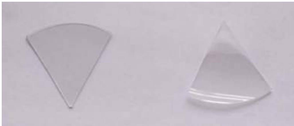
Figura 161 Campione Zendura: a sinistra prima dell'immersione a 70°C; a destra dopo l'immersione a 70°C
