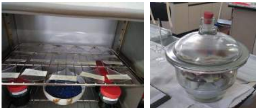
Figura 125 Procedura per il raggiungimento del peso costante per i campioni. A sinistra si vedono gli spicchi messi in stufa a 37°C con silica gel. A destra si vedono gli spicchi all'interno dell'essiccatore a 23°C
