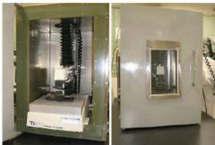
Figura 63 Macchina di prova universale e zona di temperatura costante utilizzata per la prova di trazione
