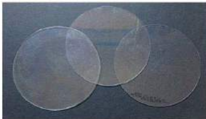
Figura 68 Membrane termoplastiche di tre tipi di materiale. A sinistra si ha la membrana costituita con la miscela binaria PETG/PC2858 che ha dimensioni e trasparenza simili alle membrane di uso comune. Al centro si ha la membrana Biolon, mentre a destra si trova la membrana Erkodur
