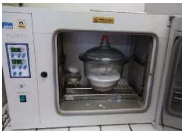
Figura 222 Nella figura di sinistra si ha il posizionamento dei campioni all'interno del primo essiccatore alla temperatura di 37°C; nella figura di sinistra, destra si osservano i campioni all'interno del secondo essiccatore a 20°C
