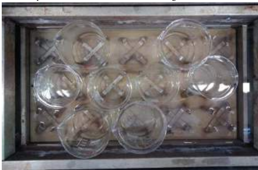
Figura 223 Bagno termostato per il mantenimento della temperatura costante a 37°C durante la prova di assorbimento di acqua
