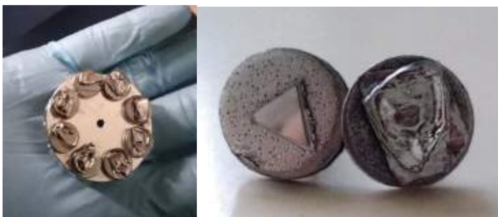
Figura 167 A sinistra si riporta lo stub per il collocamento dei porta-campione da inserire nel SEM-FEG; a destra i porta-campione in dettaglio con sopra i campioni metallizzati con Cromo.
