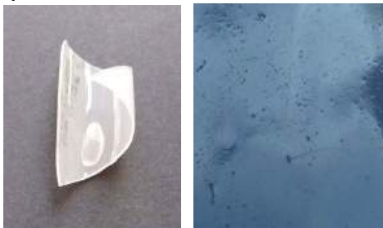
Figura 148 A sinistra si osserva più in dettaglio il campione Erkodur dopo l'immersione a 70°C; a destra è riportato uno zoom della superficie del campione dopo 6 giorni di immersione a 70°C
