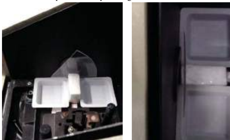
Figura 115 Posizionamento dei campioni all'interno dello spettrofotometro UV-visibile
