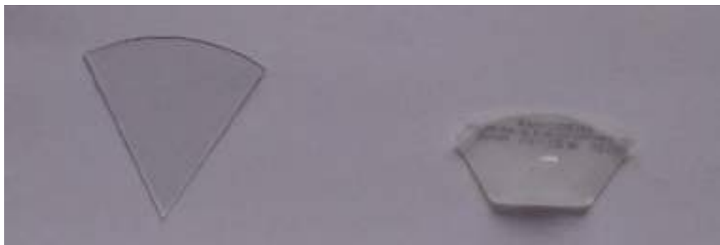
Figura 147 Campione Erkodur: a sinistra prima dell'immersione a 70°C; a destra dopo l'immersione a 70°C
