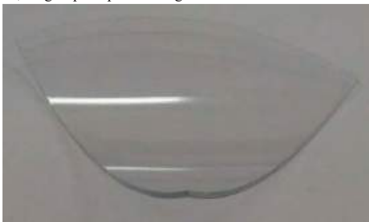
Figura 152 Campione Essix Plastic dopo 1 h 30' di immersione a 70°C. Evidente la deformazione iniziale del pezzo
