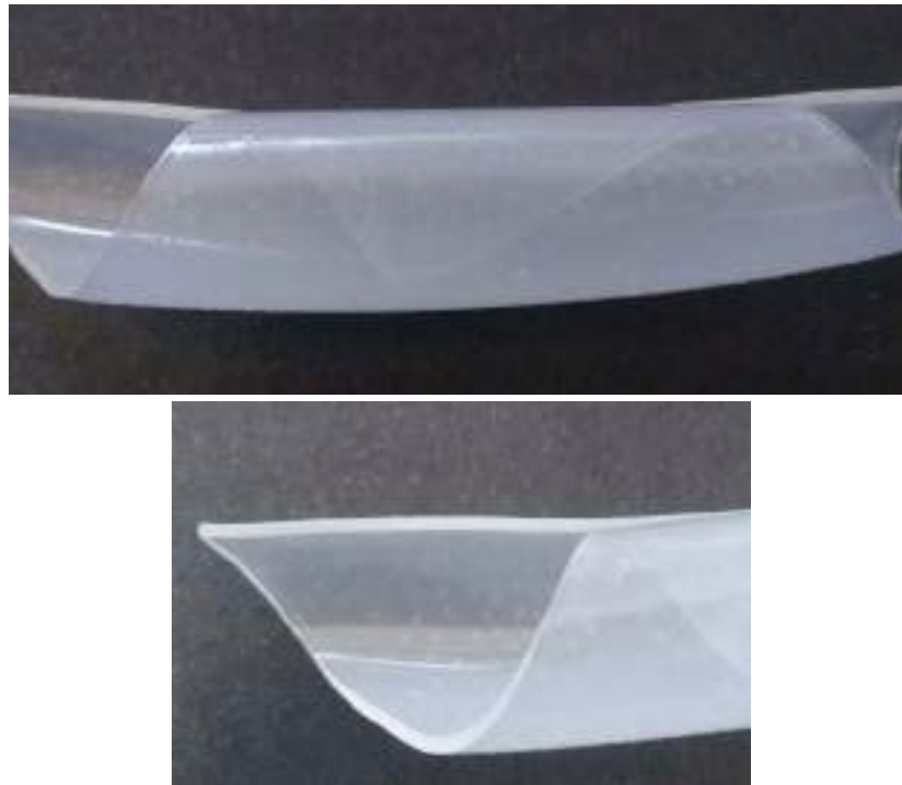
Figura 158 Formazione di bolle superficiale sui campioni Ghost Aligner dopo 6 giorni di permanenza a 70°C
