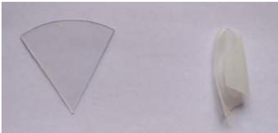
Figura 156 Campione Ghost Aligner: a sinistra prima dell'immersione a 70°C; a destra dopo l'immersione a 70°C
