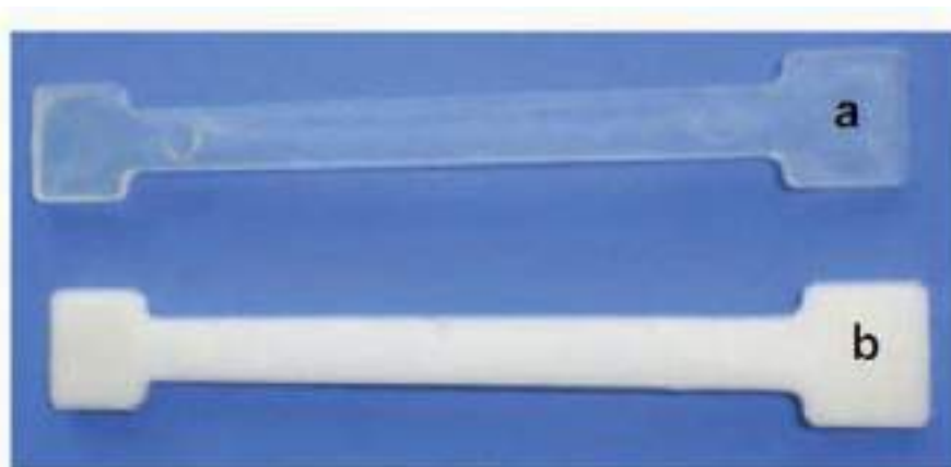
Figura 42 Fenomeno della plastificazione del TPU: (a) campione non invecchiato, (b) campione invecchiato igrotermicamente a 90°C per 15 giorni.
