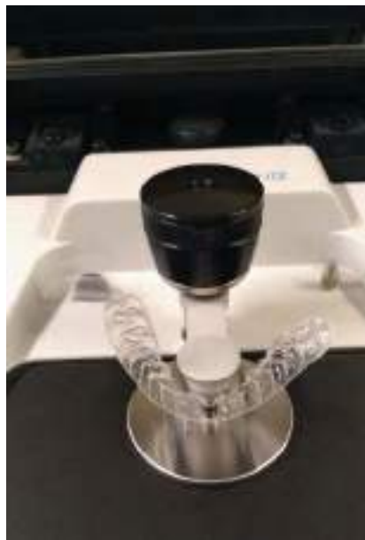
Figura 205 Posizionamento del campione all'interno dello spettrometro IR
