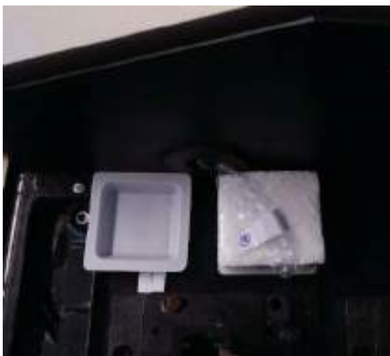
Figura 213 Posizionamento del campione all'interno dello spettrofotometro UV-visibile
