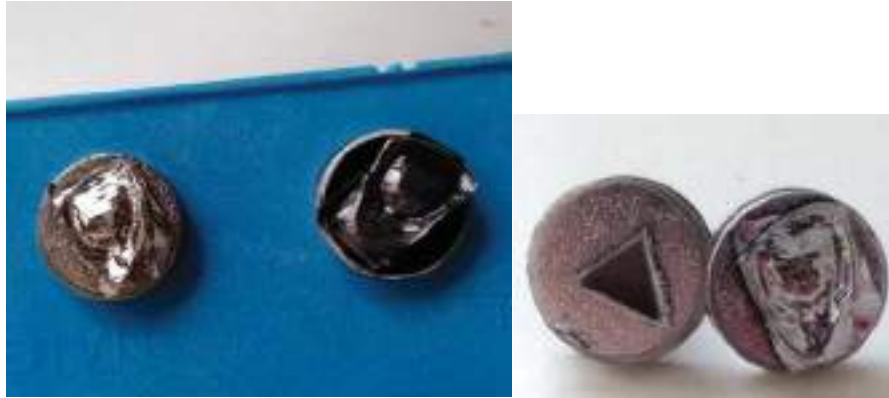
Figura 230 A sinistra si osservano due campioni presi dagli allineatori uno metallizzato (a sinistra) e uno senza metallizzazione (a destra); a destra i porta-campione in dettaglio con sopra i campioni metallizzati con Cromo
